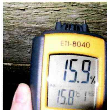
Fot. 5. Pomiar wykazał 15,9% wilgotności bezwzględnej drewna, co jest równoważne 13,7% wilgotności względnej.
